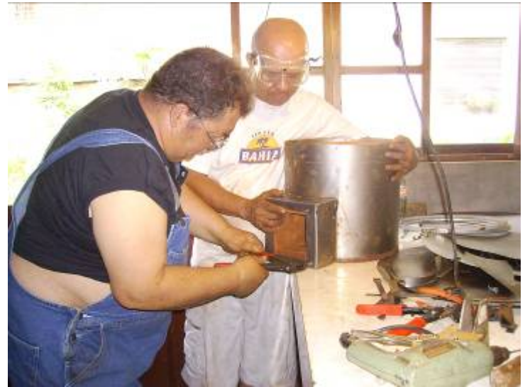
Larry y Gustavo, haciendo ajustes en la entrada del quemador Rocket
