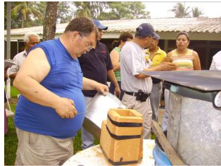
Cocina elaborada a partir de un barril de 14" en este caso el agua hirvió en 23 minutos fotografía "B"
