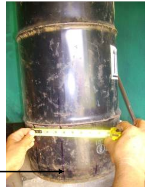
Se mide la altura y lo ancho (fig. A) del codo para hacer el hoyo en el barril, lo mas ajustado posible
