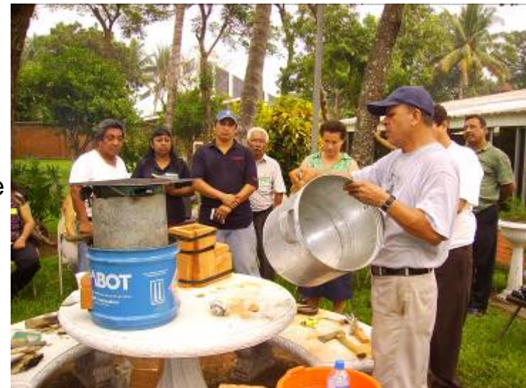
Cocina elaborada a partir de un barril de 14" en este caso el agua hirvió en 23 minutos fotografía "B"
